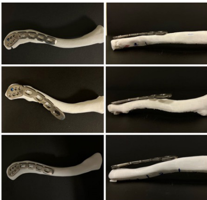
Şekil 2. Aynı plak konfigürasyonunun farklı 3D klavikula kemik baskılarındaki yerleşimi
