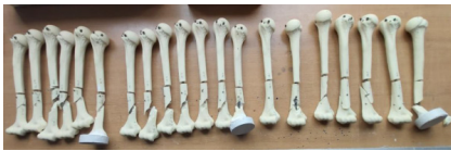
Şekil 1. Torsiyon testinde kırılan kompozit humerus modelleri
