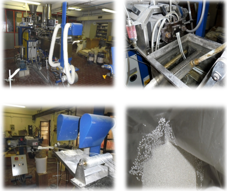
Resim 1. Pisa Üniversitesi (İtalya) Malzeme Mühendisliğine ait ekstruder makinesi üretim hattı ve üretilen kalsit dolgulı kompaund görünümü
