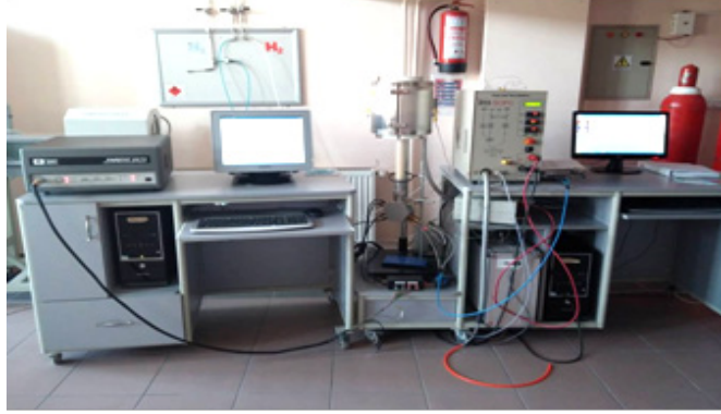
Şekil 2. Yakıt pili test istasyonu ve elektrokimyasal sistem.
