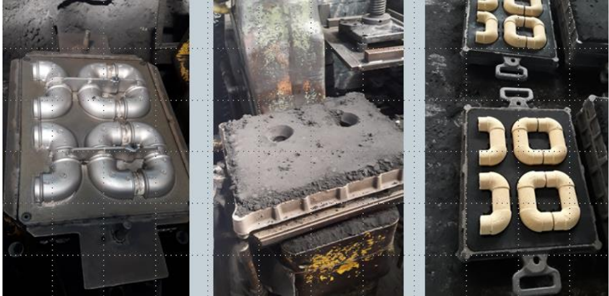
Şekil 2: Derece Kalıplama (Maçalı Ürün)
