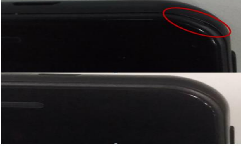
Şekil 26. Kılıflı ve kılıfsız cep telefonu modellerine uygulanan düşme testi sonucunda taşıyıcı parça üzerindeki kalıcı şekil değiştirme
