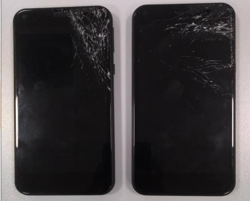
Şekil 4. Cep telefonunun 2250 mm'den yüzey atışı sonrası camdaki hasar
