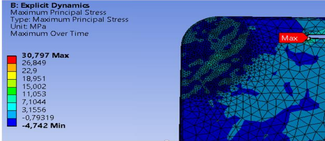
Şekil 23. Kılıflı model için cam üzerinde oluşan maksimum asal gerilme
