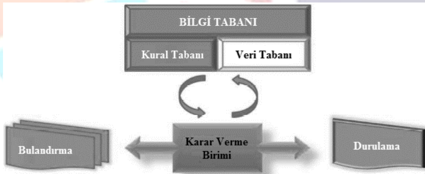
Şekil 3: Bulanık mantık sisteminin yapısı [14]
