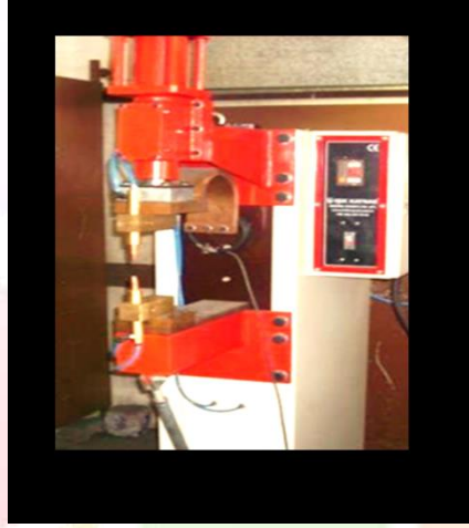
Şekil 2. Deneylerde kullanılan elektrik direnç nokta kaynak makinesi
