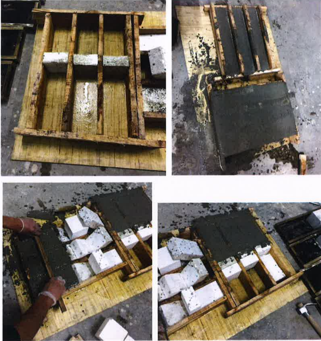
Şekil 3.6. Çalışmada yapılan prizma numunelerine betonların yerleştirme ve perdah yapma şekilleri
