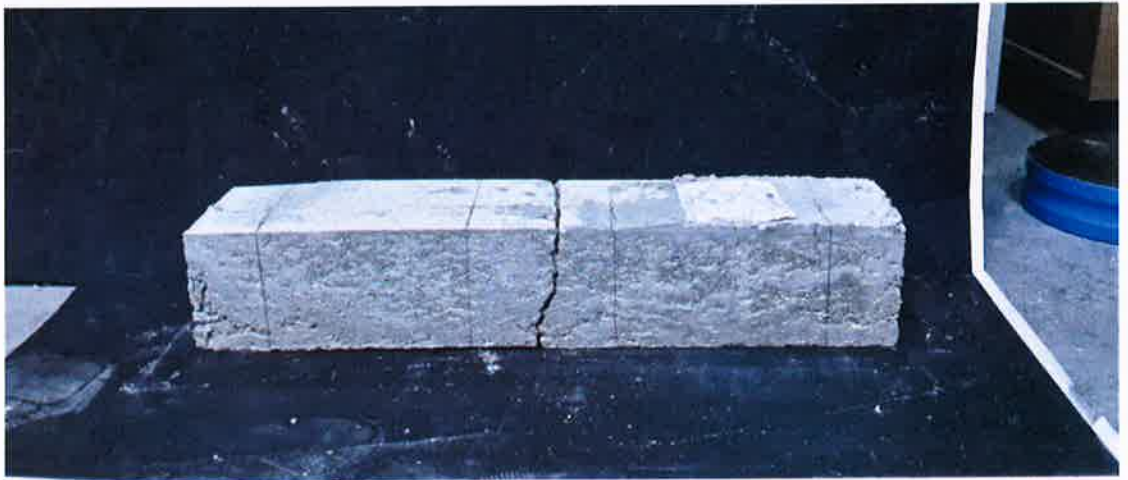
Şekil 4.19. Eğilme dayanımı deneyi uygulanmış tam dolu prizma numuneleri
