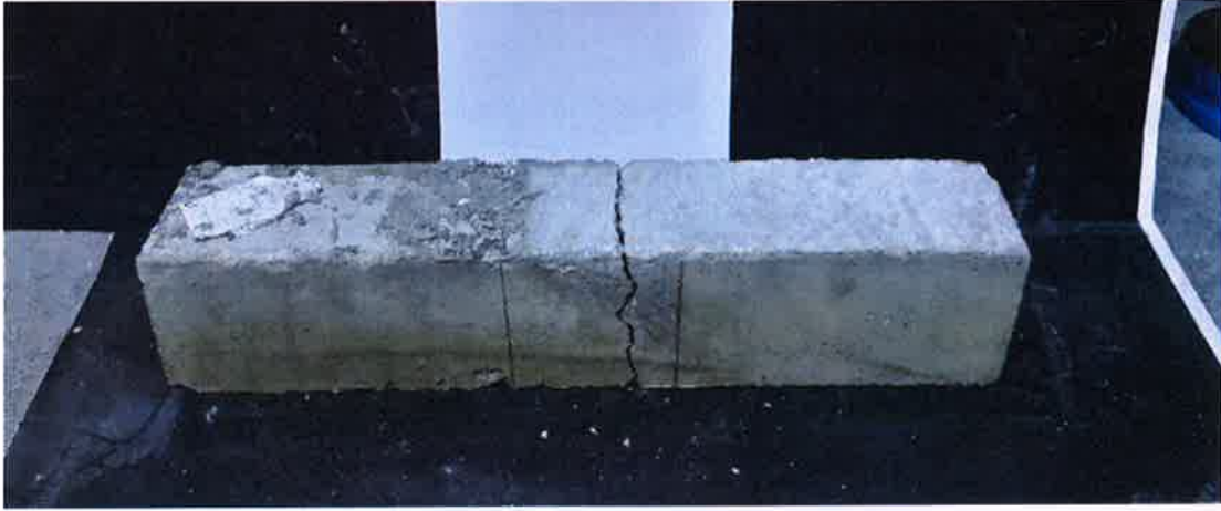
Şekil 4.17. Eğilme dayanımı deneyi epoksi yapıştırıcılı 45 derece açılı soğuk derz uygulanmış prizma numuneleri
