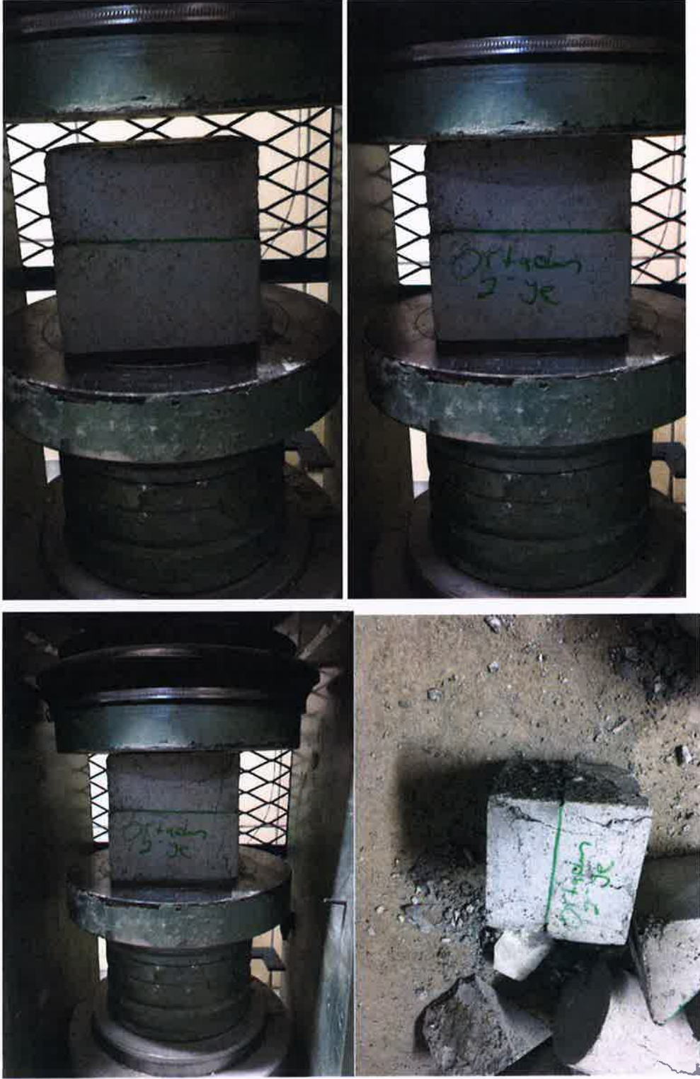
Şekil 4.5. Basınç dayanım deneyinde kullanılmış 90 derece açılı soğuk derz küp numuneleri
