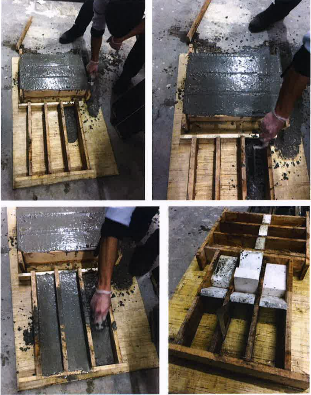
Şekil 3.5. Çalışmada yapılan prizma numunelerine betonların yerleştirme şekilleri
