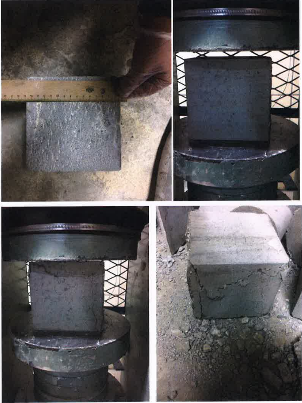
Şekil 4.3. Basınç dayanım deneyinde kullanılmış kontrol küp numuneleri
