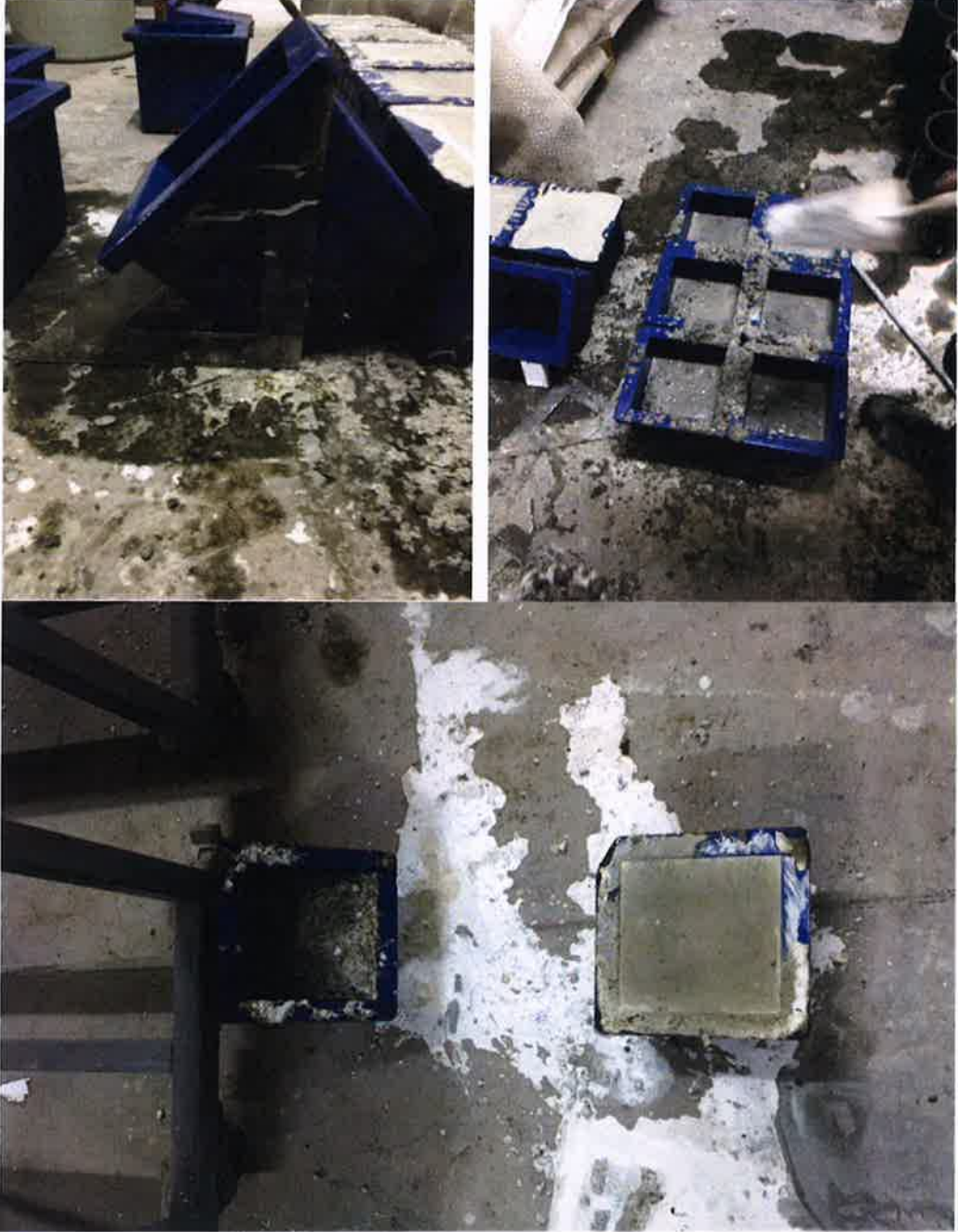
Şekil 3.2. Çalışmada yapılan küp numunelerine betonların yerleştirme şekilleri
