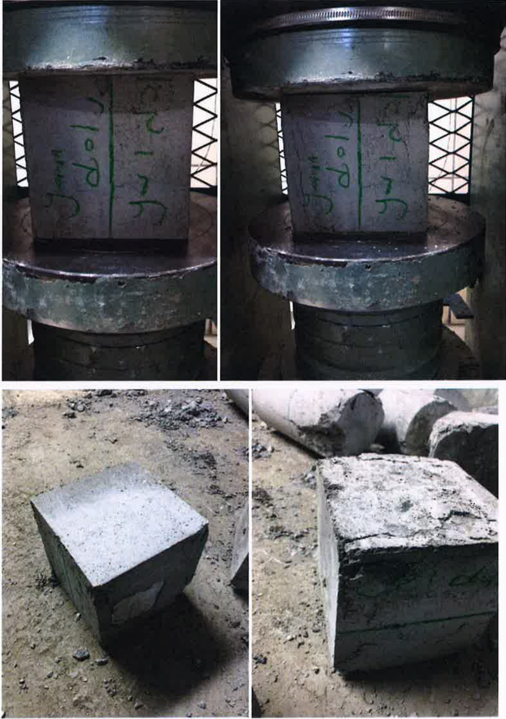
Şekil 4.6. Basınç dayanım deneyinde kullanılmış yarı dolu soğuk derz küp numuneleri
