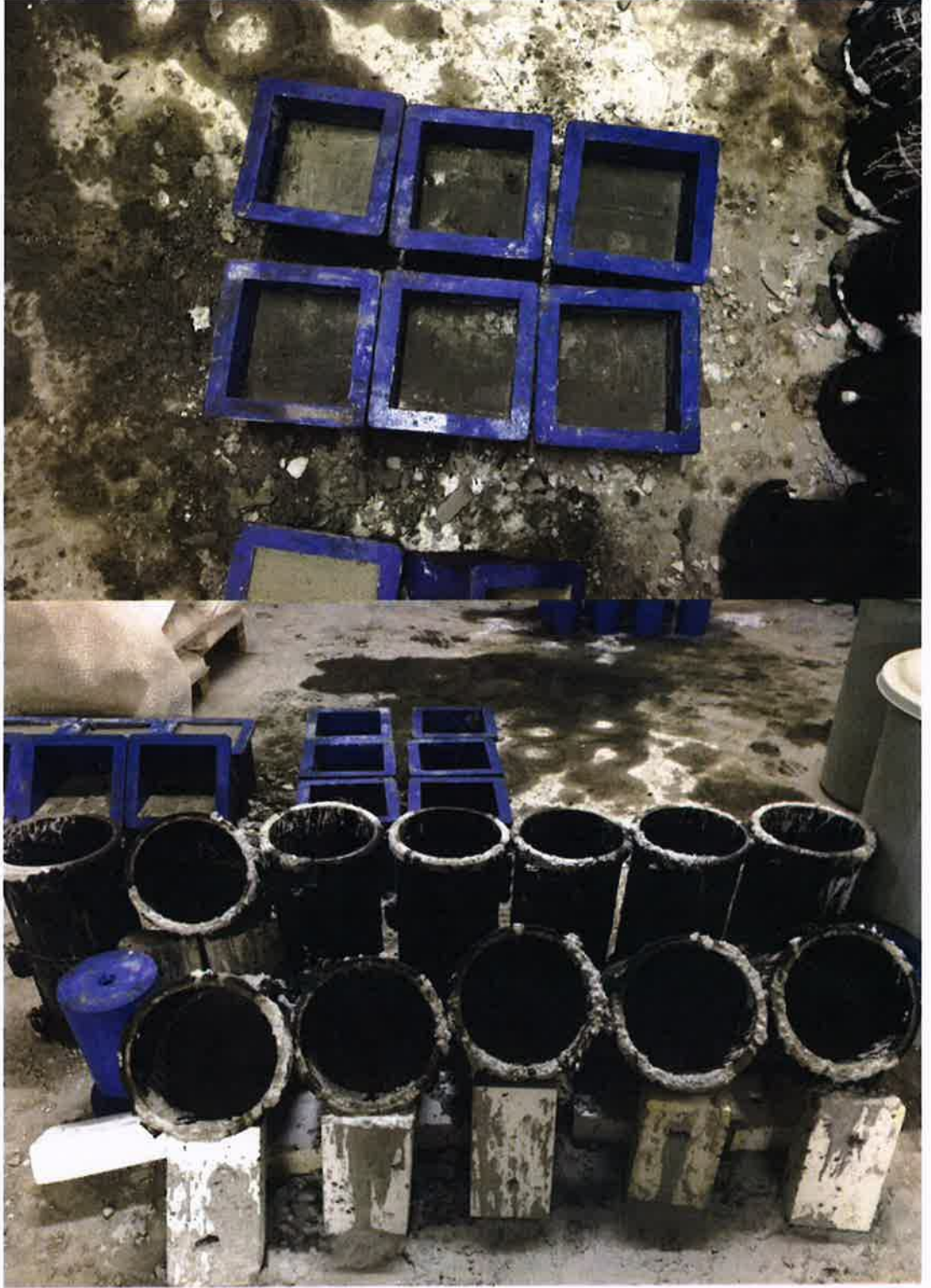
Şekil 3.3. Çalışmada yapılan küp ve silindir numunelerine betonların yerleştirme şekilleri
