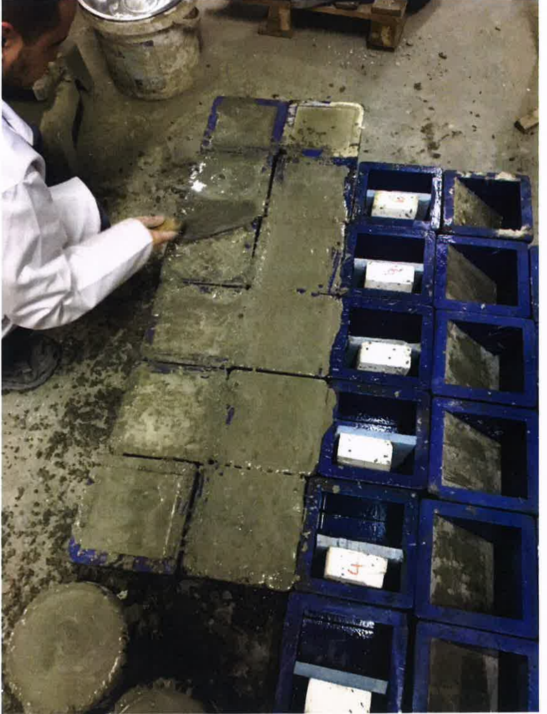
Şekil 3.4. Çalışmada yapılan küp numunelerine betonların yerleştirme şekilleri
