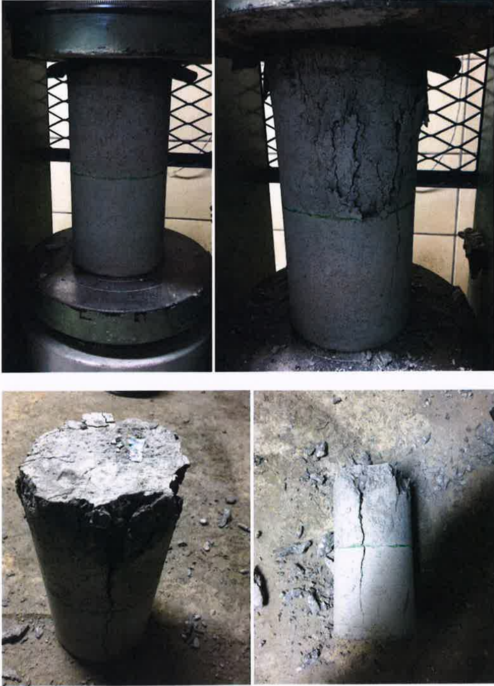
Şekil 4.2. Basınç dayanım deneyinde kullanılmış 90 derece açılı soğuk derz silindir numuneleri
