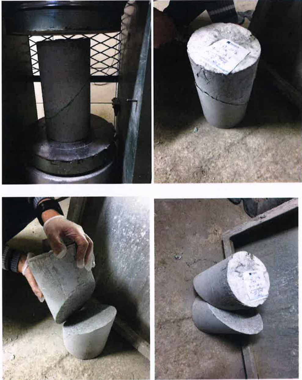
Şekil 4.1. Basınç dayanım deneyinde kullanılmış 45 derece açılı soğuk derz silindir numuneleri
