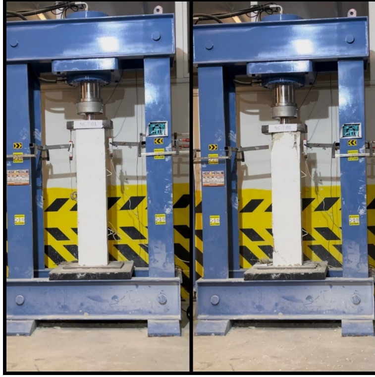
Şekil 32. NC-T:01 kolon numunesinin deney öncesi ve sonrası durumu
