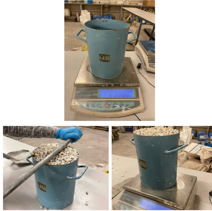
Şekil 15. Sıkı ve gevşek birim hacim deneyi
