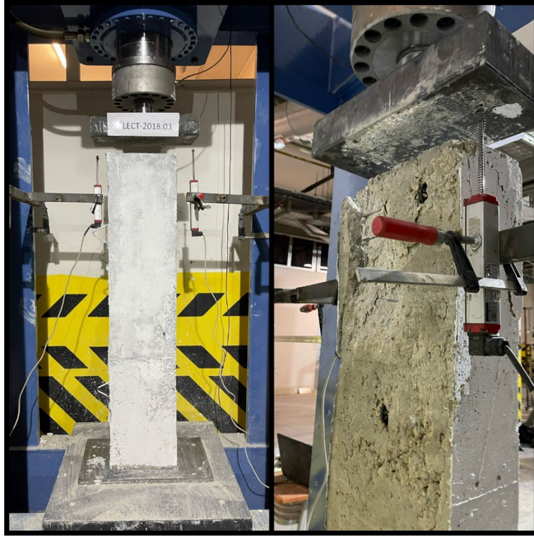
Şekil 59. LECT-2018:03 kolon numunesinin deney öncesi ve sonrası durumu
