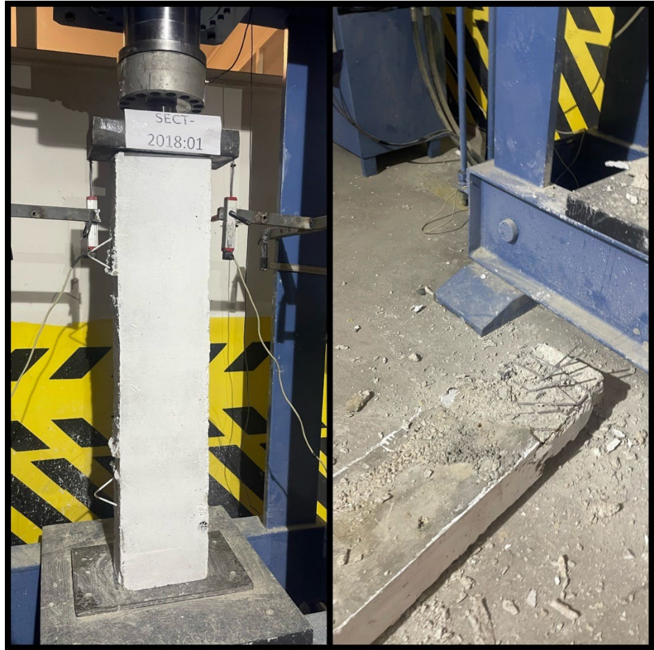
Şekil 52. SECT-2018:01 kolon numunesinin deney öncesi ve sonrası durumu
