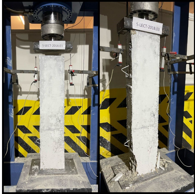
Şekil 64. S-LECT-2018:03 kolon numunesinin deney öncesi ve sonrası durumu
