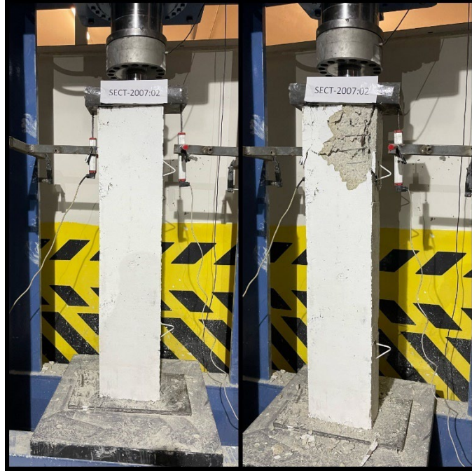
Şekil 38. SECT-2007:02 kolon numunesinin deney öncesi ve sonrası durumu
