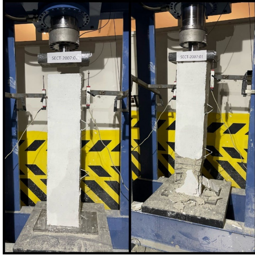
Şekil 37. SECT-2007:01 kolon numunesinin deney öncesi ve sonrası durumu
