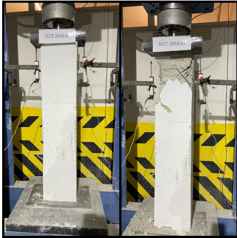
Şekil 54. SECT-2018:03 kolon numunesinin deney öncesi ve sonrası durumu
