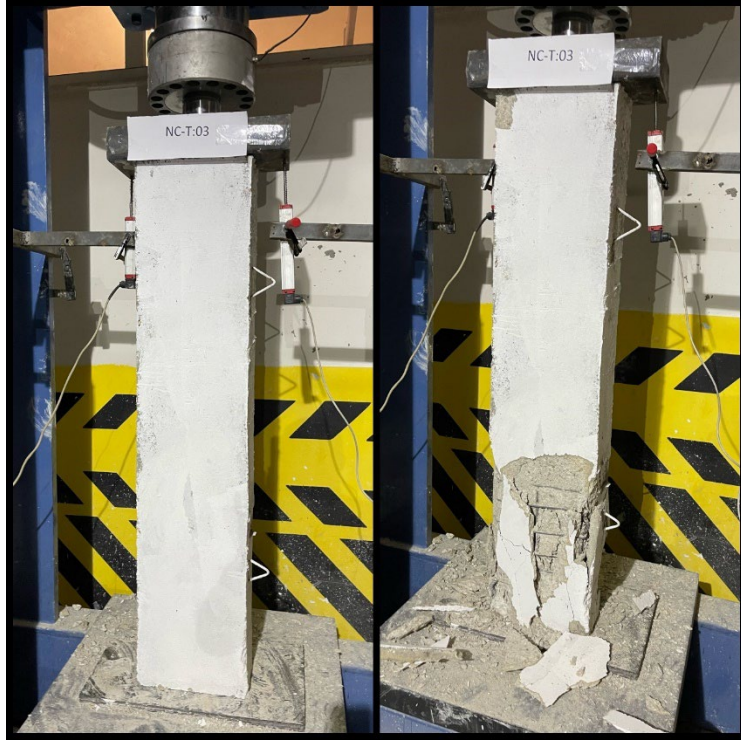
Şekil 34. NC-T:03 kolon numunesinin deney öncesi ve sonrası durumu
