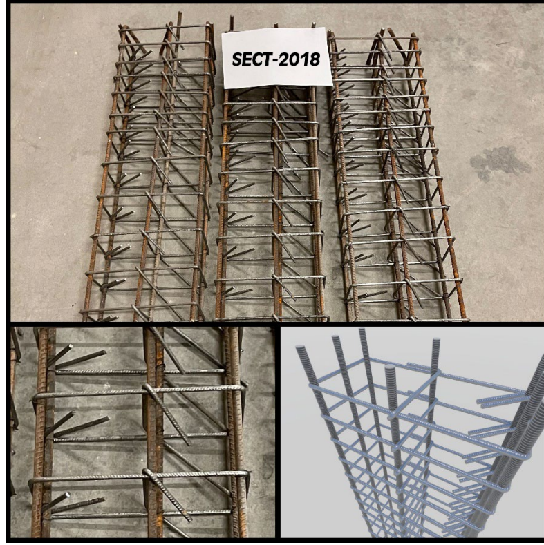
Şekil 25. SECT-2018 (2018 TB DY'ye gre kısa ynde iroz bađlanan numuneler)
