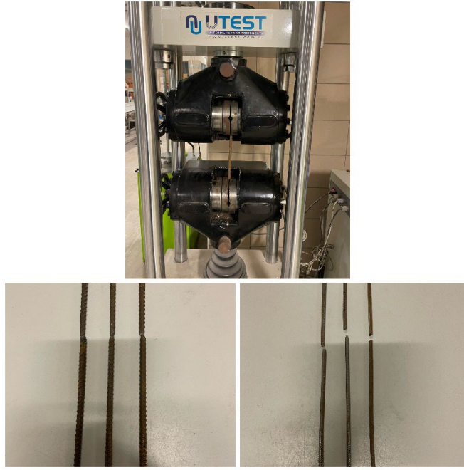
Şekil 14. Donatı dayanım testi ve alınan donatı numuneleri
