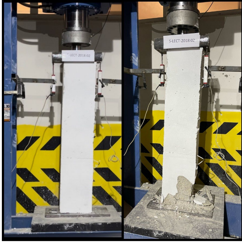
Şekil 63. S-LECT-2018:02 kolon numunesinin deney öncesi ve sonrası durumu
