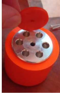
Şekil 28. Denenen Yüzey Alanı Geniş Silikon Teker
