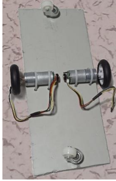
Şekil 24. Motorların Kablo Bağı ile Bağlanma Deneyi
