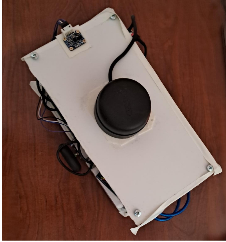
Şekil 4. Mobil Robotun Üzerinde LIDAR Yerleşimi
