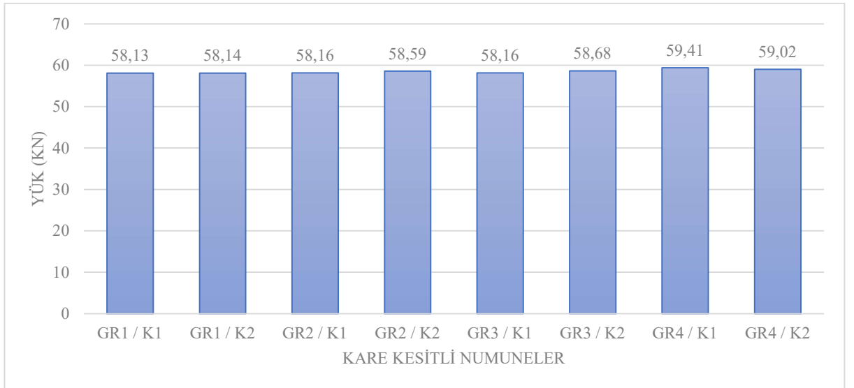
Şekil 57. Kare kesitli kesitli kirişlere ait akma noktasındaki yük grafiği
