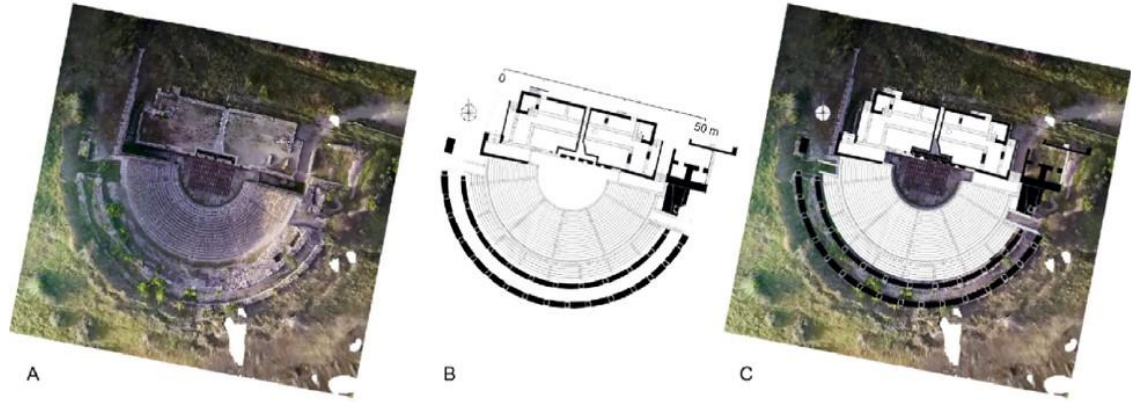
Şekil 45. A-amfi tiyatro görsellerinden elde edilen ortoplan, B-Amfi tiyatro ölçekli çizimi, C-Çizim ve ortoplanın örtüştürülmesi
