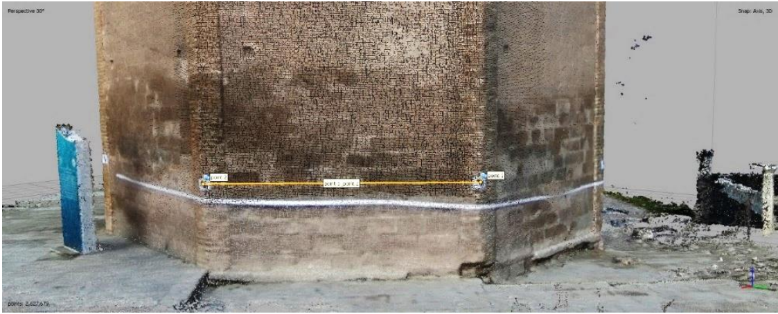
Şekil 55. İşaretçi noktalar arasında referans ölçü (3.80m) girilmesi
