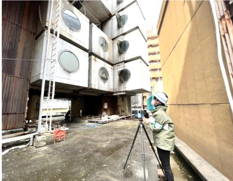
Şekil 22. Nakagin Kapsül Kulesi, lazer tarama ve görüntü kaydı alma süreci
