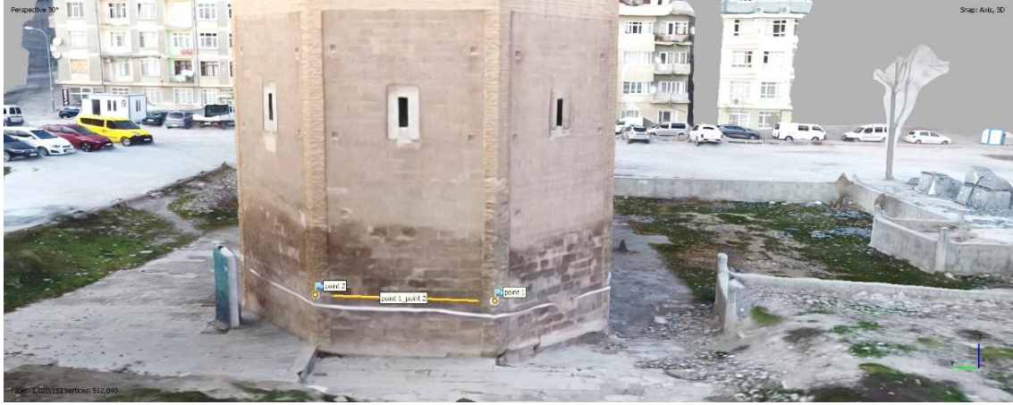
Şekil 75. Agisoft Metashape – İşaretçiler üzerine atılan referans noktalar ve bu noktalar arasında değer girilen referans çizgi
