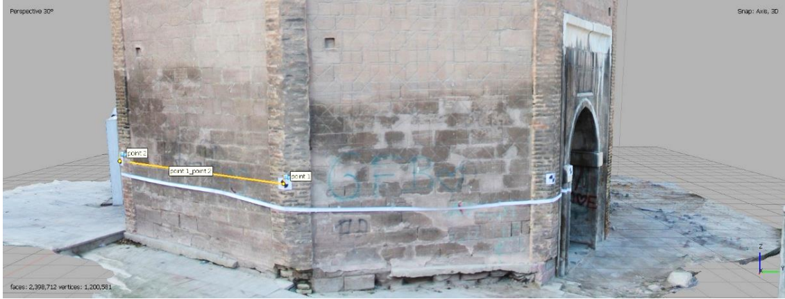
Şekil 66. Agisoft Metashape - İşaretçi noktalar arasında referans ölçü (3.80m) girilmesi
