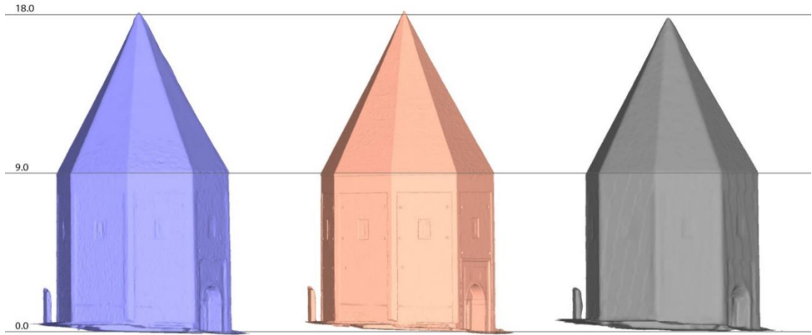
Şekil 82. Üç farklı cihaz ile alınmış görüntülerden oluşturulan 3B dijital modellerin ölçekli bir halde kotlarının gösterilmesi
