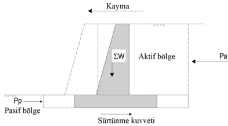
Şekil 1. Dayanma duvarında kayma tahkiki
