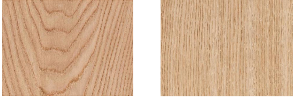
Şekil 22. A) Hareli kaplama, B) Radyal (freze) kaplama
