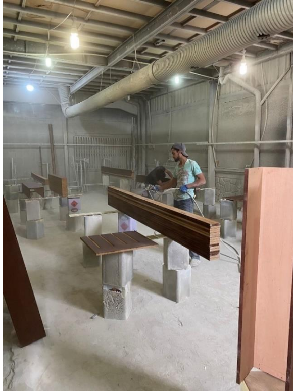
Şekil 96. Basınçlı hava yardımıyla uygulanan boya işlemi, Konya marangoz atölyesi
