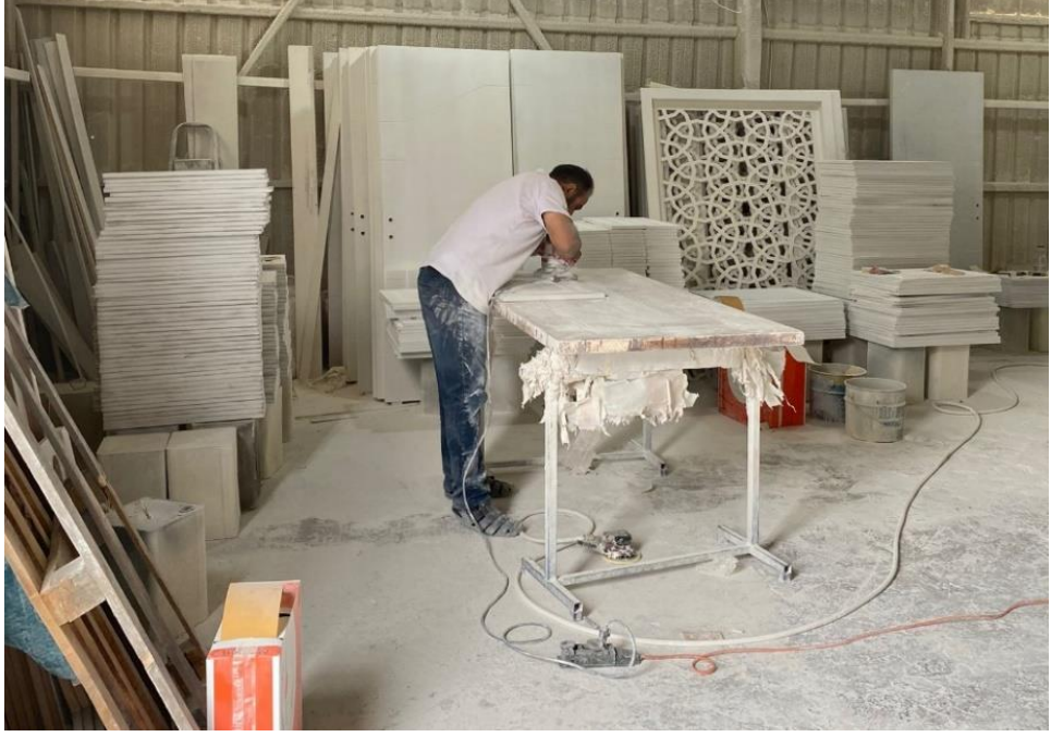
Şekil 93. MDF levha yüzeyine astar uygulamasının yapılabilmesi için yapılan yüzey pürüzsüzleştirme işlemi, Konya marangoz atölyesi
