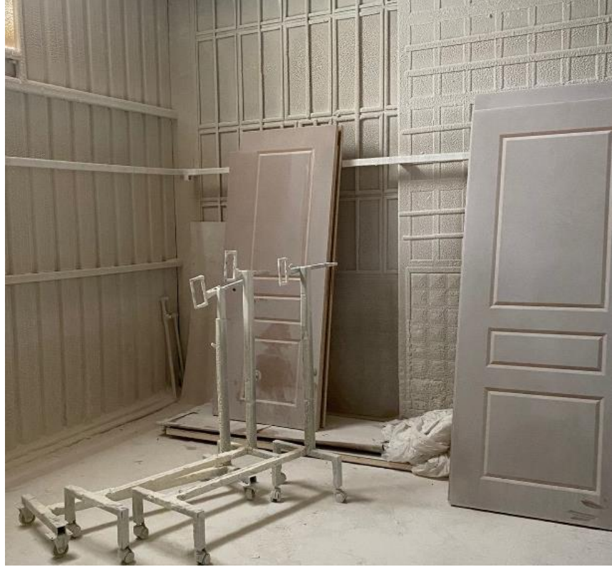
Şekil 94. Kapı yüzey kaplamasında bulunan MDF levhaya ilk kat astar uygulanmış hali, Konya marangoz atölyesi
