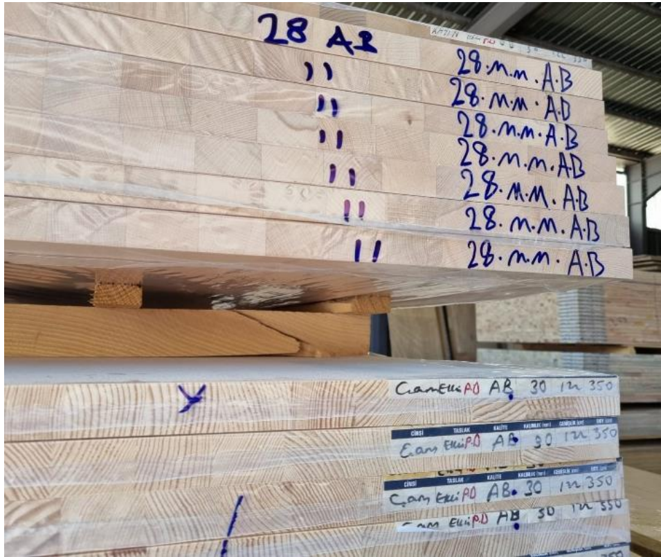
Şekil 17. Konya satış mağazası kayın ve çam ağaçlarından elde edilen masif panelin kesiti
