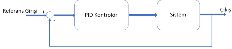
Şekil 9. PID Kontrolör Kapalı çevrim Blok Diagramı
