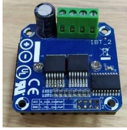
Şekil 7. Motor Sürücü IBT-2 Modülü
