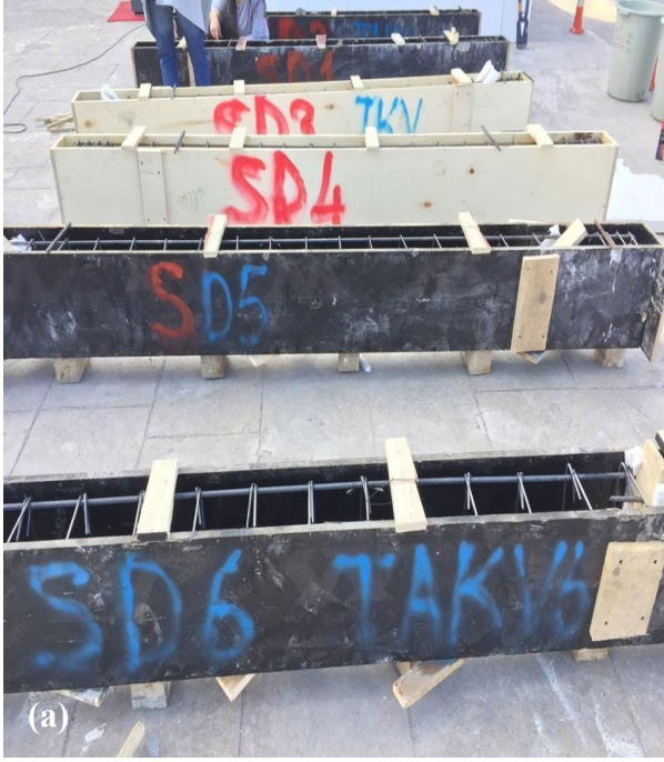
Şekil 9. Beton dökümü (a) hazır olan numune kirişler (b) döküm aşaması
