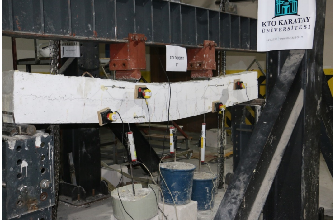
Şekil 41. CJ0 kirişi yükleme anında çatlama durumu
