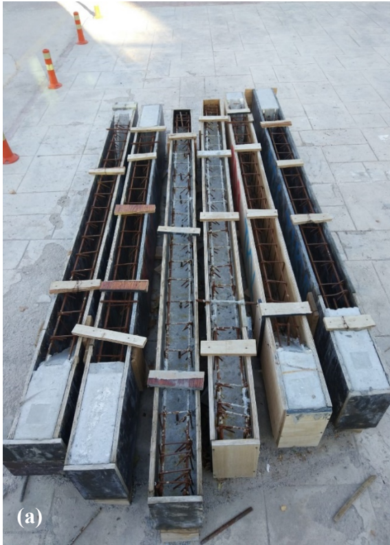
Şekil 10. Soğuk derzli numuneler (a) ilk döküm sonrası (b) ikinci döküm aşaması
