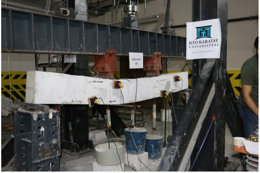
Şekil 33. CJ45 kirişi yükleme anında çatlama durumu
