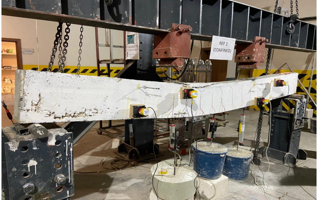
Şekil 13. Ref-1 Confined kiriş numunesinin yükleme anında çatlak oluşumu
