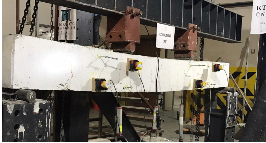
Şekil 25. CJ90 kirişi yükleme anında çatlama durumu
