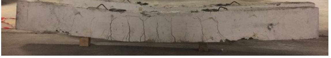
Şekil 35. Deney sonrası CJ45 kiriş deney elemanı
