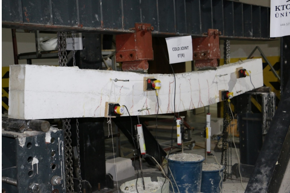
Şekil 37. CJ0R kirişi yükleme anında çatlama durumu
