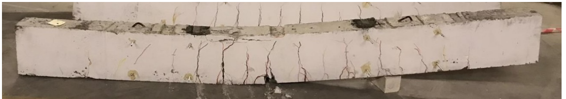
Şekil 27. Deney sonrası CJ90 kirişi deney elemanı
