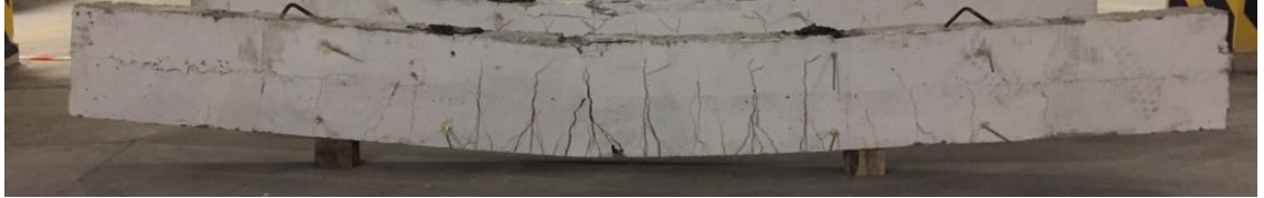
Şekil 39. Deney sonrası CJ0R kiriş deney elemanı
