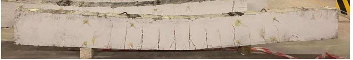
Şekil 23. Deney sonrası CJ90R kiriş deney elemanı
