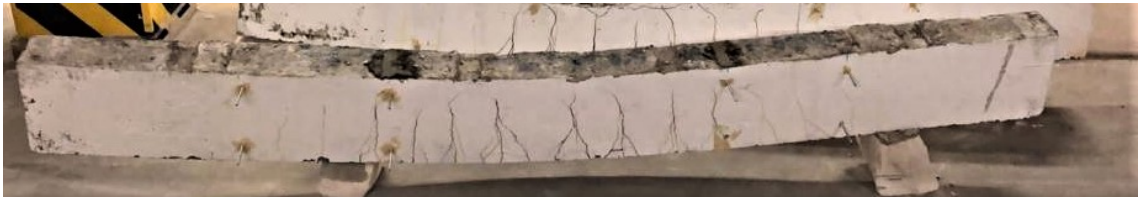
Şekil 19. Deney sonrası Ref-2(Unconfined) kiriş deney elemanı
