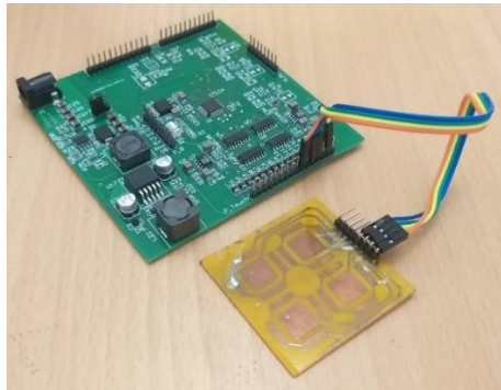
Şekil 3. Tasarlanan devre kartı ve butonlarla bağlantısı
