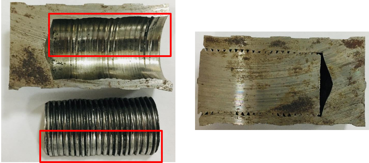
Şekil 3. Ezilmiş parçanın kesit görüntüsü.
