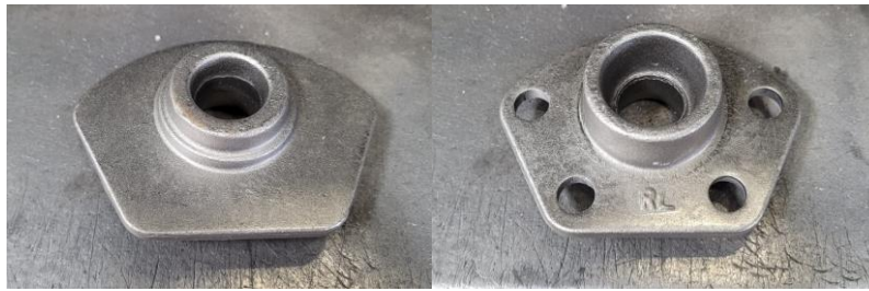
Şekil 2. Delme işlemi öncesi ve sonrası yaprak rotül
