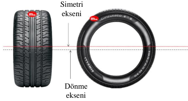
Şekil 2. Lastikte statik balanssızlık
