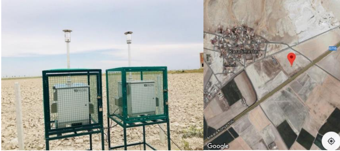
Şekil 3. 2018 yılı araziye kurulan TCR Tecora cihazları ve arazideki konumu
