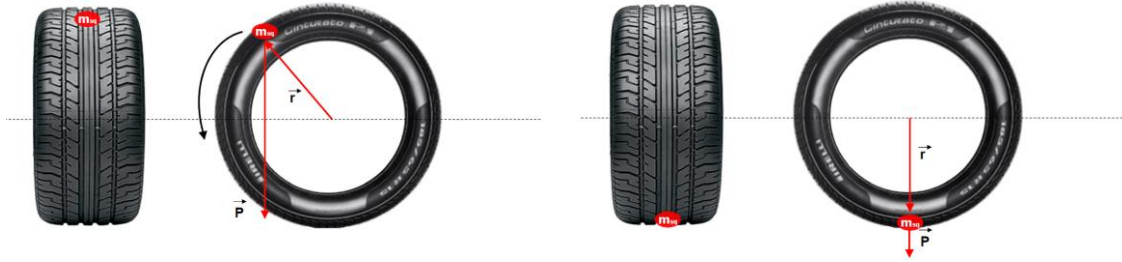
Şekil 3. Lastikte statik balanssızlıkta oluşan moment ve dönme etkisi
