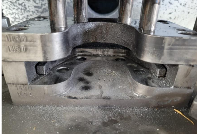
Şekil 4. Delme kalıbı iç plakasına yerleştirilen tutucu mıknatıslar
