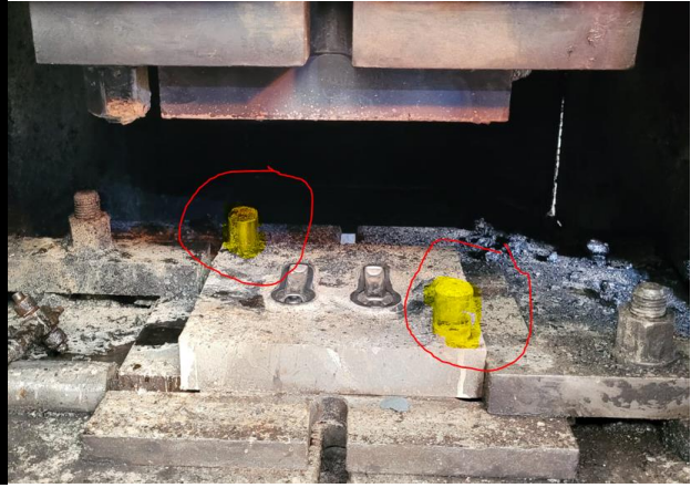
Şekil 6. Pimli kalıp sistemi ve pimlerin zamanla deformasyonu
