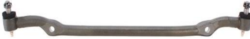
Şekil 5. Sıcak dövme yöntemiyle üretilmiş bir orta rot.
