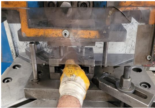
Şekil 3. Delik delme işlemi pres anı
