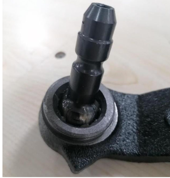
Şekil 4. Nitrox işlemi uygulanmış mafsals.
