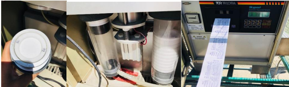
Şekil 5. Tecora cihazlara kasetlerin yüklenmesi ve ölçüm sonuç çıktılarının alınması
