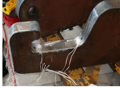
Şekil 3. Kancanın kritik noktalarına sensörlerin yerleştirilmesi
