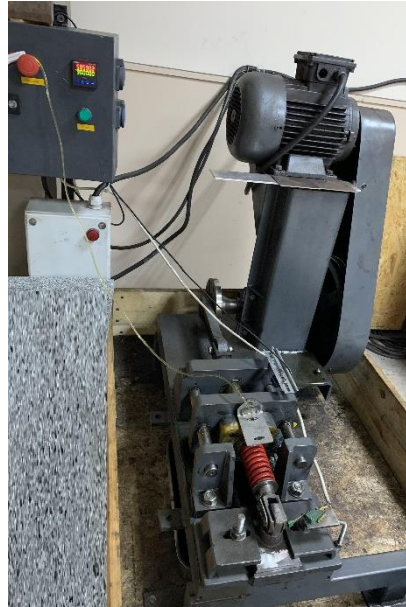
Şekil 8. Yapıştırma bağı için geliştirilen yorulma test cihazı
