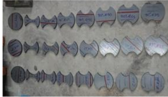
Şekil 3. ASTM-ES standartlarına göre hazırlanan çekme test numuneleri
