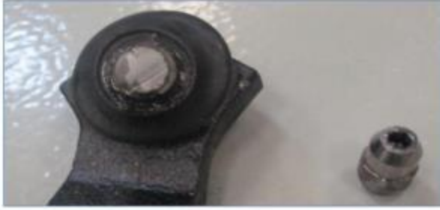
Şekil 3. Oluk bölgesinden kırılmış bir mafsal.
