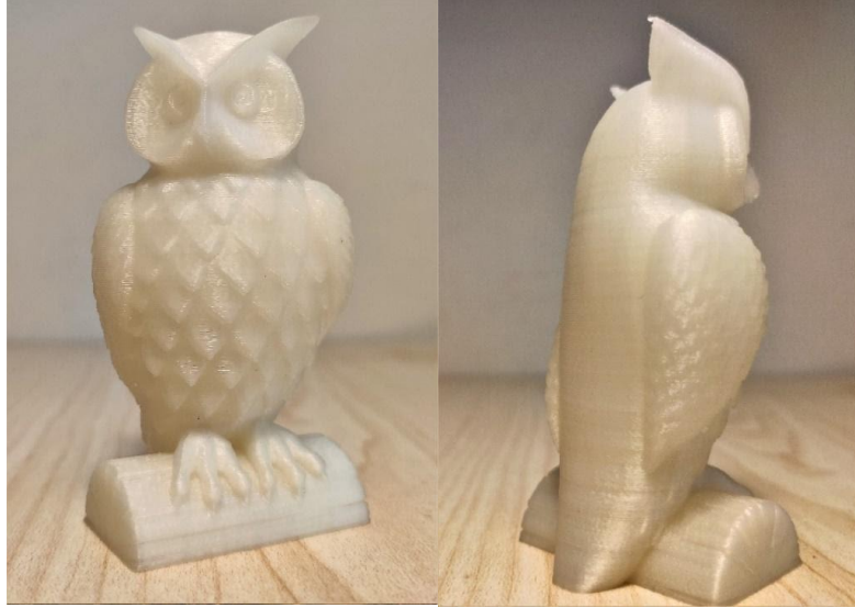
Şekil-7: Üretilen filament ile 3B baskı örneği
