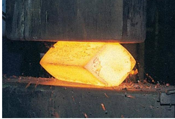
Şekil 2. Açık kalıpta alt ve üst basit geometri kalıplar ve ön şekil verme işlemi
