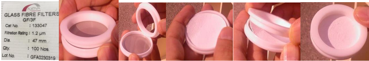
Şekil 4. Ölçümlerde kullanılan filtre kağıtları ve cihaz kasetine yerleştirilmesi
