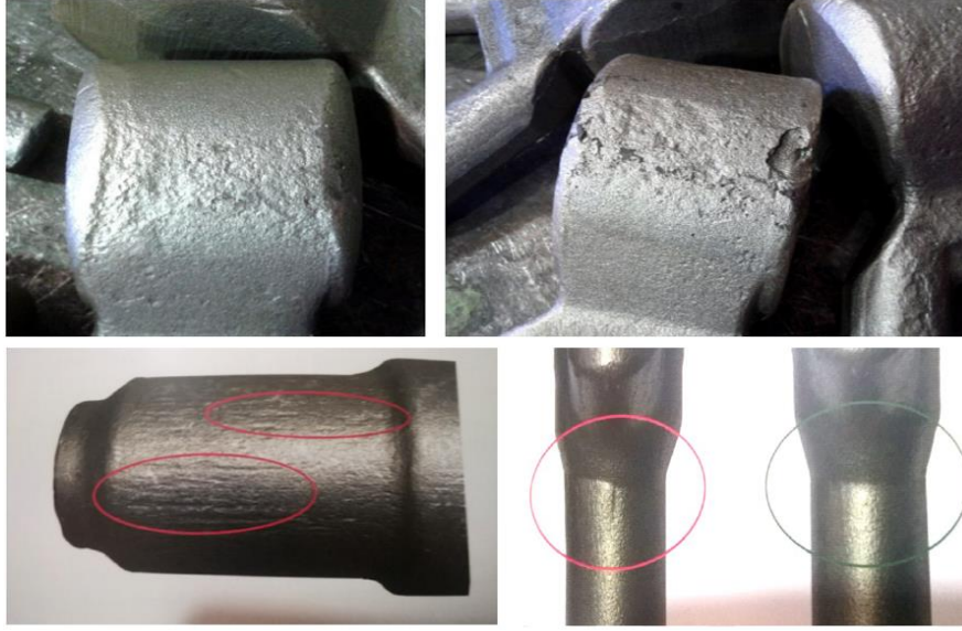
Şekil 5. Yağlayıcıların eksikliği kaynaklı hurda parçalar
