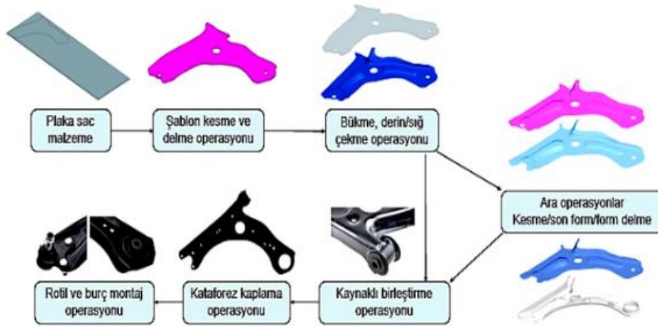
Şekil 2. Sac salıncak üretim yöntemi
