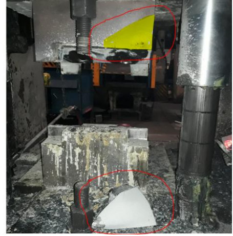
Şekil 5. Kuleli kalıp sistemi ve kalıp kulesi kırılması
