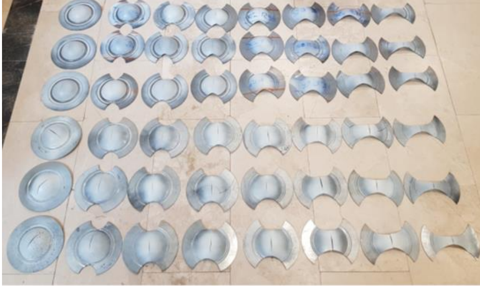
Şekil 4. ISO 12004-02 standartlarına göre hazırlanan nakajima test numuneleri
