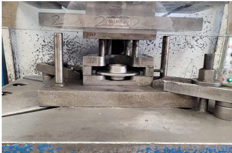
Şekil 5. Koruyucu cam montajı ile tamamlanan delik delme kalıbı
