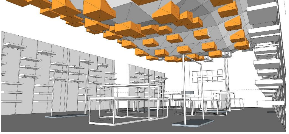
Şekil 51. Yüzey aydınlatma elemanlarının yerleştirilmesi
