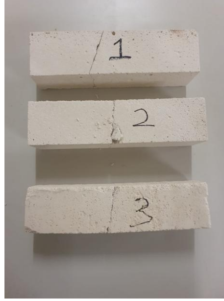
Şekil 10. Eğilmede çekme dayanım deneyi sonrası deforme olmuş numuneler
