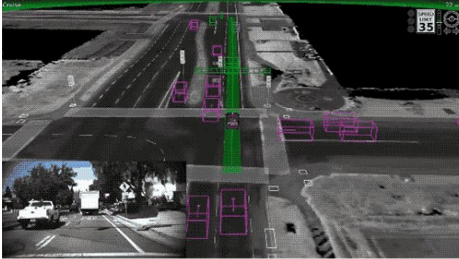
Şekil 3. Sensörlerin nesne algılama çözümü
