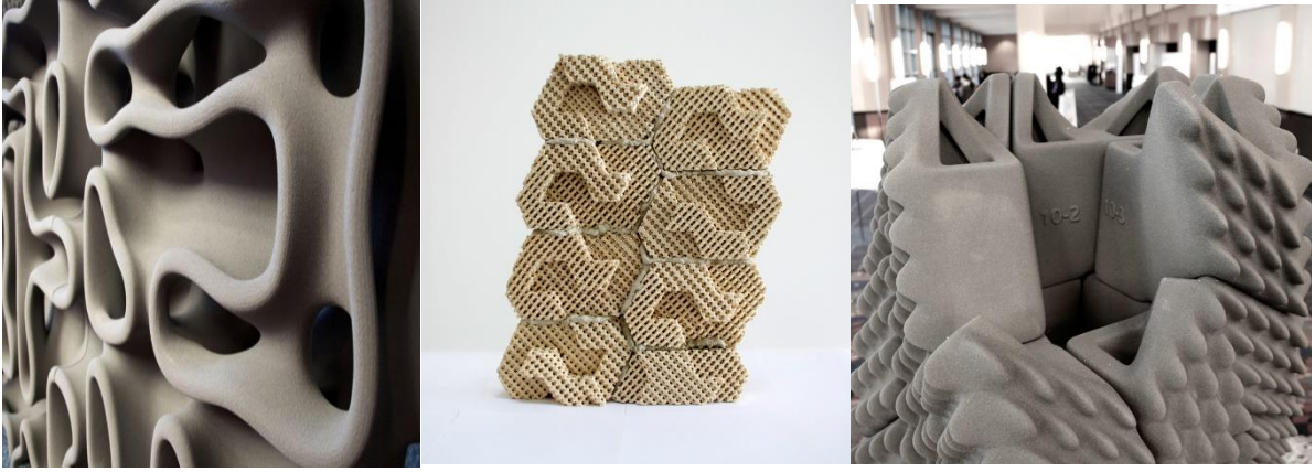
Şekil 2.4. a) Involute Wall - Girift Duvar b) "Cool Brick-Soğuk Tuğla" c) "Quake Column-Sarsıntı Kolon" (Web Adresi 5)
